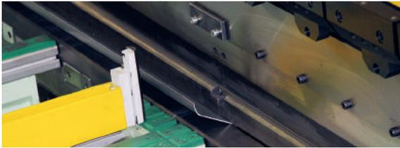
Biegen mit der Hochleistungspressse
